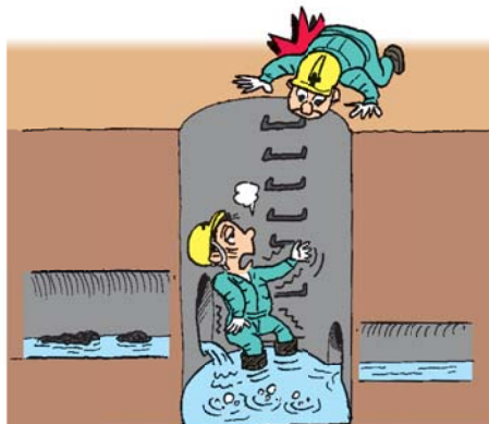
下水道工事での硫化水素中毒の例
