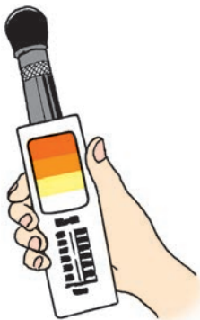
WBGT測定器（ハンディタイプの例）
