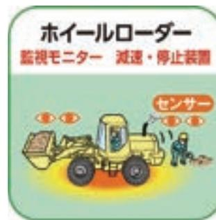
近接センサーによる減速・停止装置
