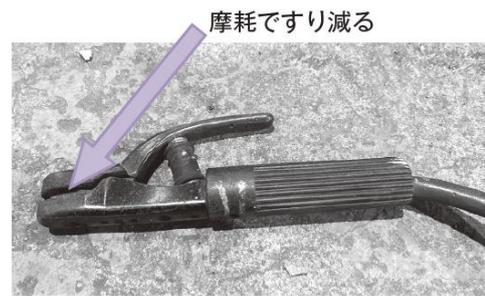
写真 3-3 溶接棒ホルダの例
