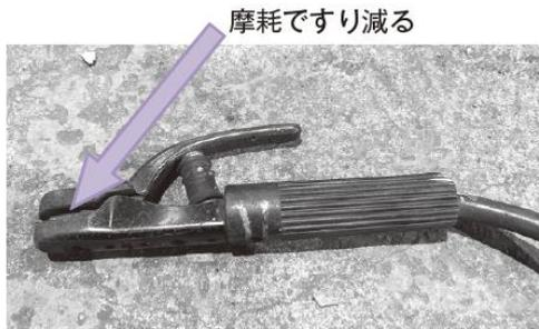
写真 3-3 溶接棒ホルダ用の例
