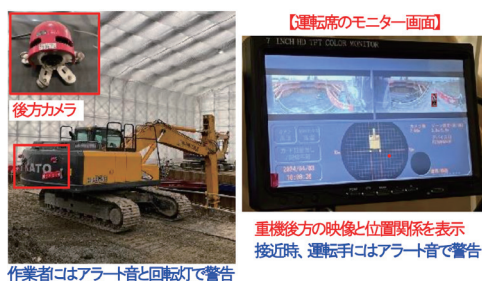
写真-7 重機セーフティカメラシステム
