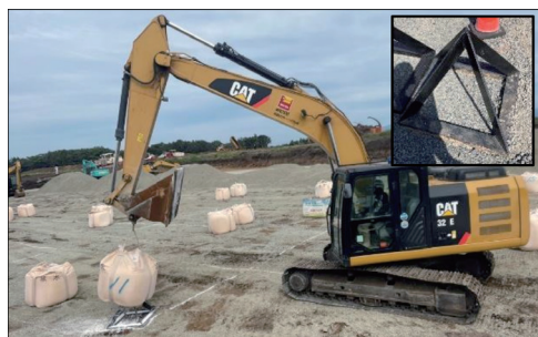
写真-6 フレコンカッター使用状況
