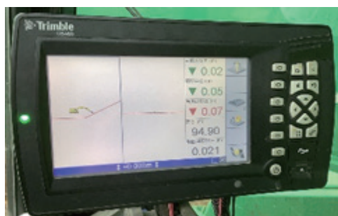
写真-2 コントロールボックス表示状況 （バックホウ運転席内）
