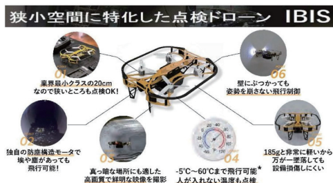
図-4 狭小空間に特化した点検ドローン IBIS
