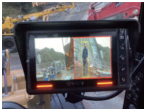
写真-4 重機用作業者検知 AI カメラ使用状況
