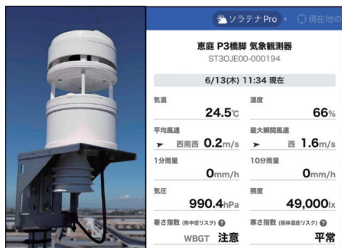
写真-3 ソラテナ Pro のセンサーと表示画面
