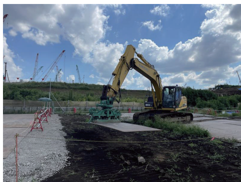
写真-3 敷鉄板マグネット付きバックホウ
