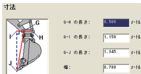
図-5 キャリブレーション (バックホウバケット)
