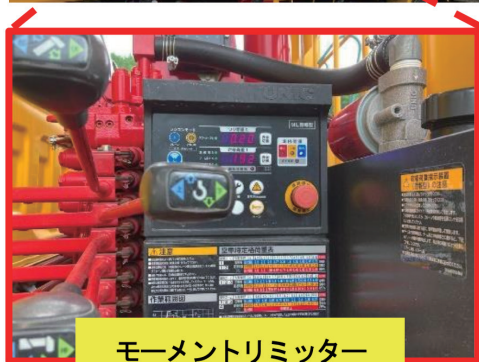
写真-5 モーメントリミッター付きユニック車
