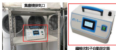
写真-4 繊維状粒子自動測定器による測定
