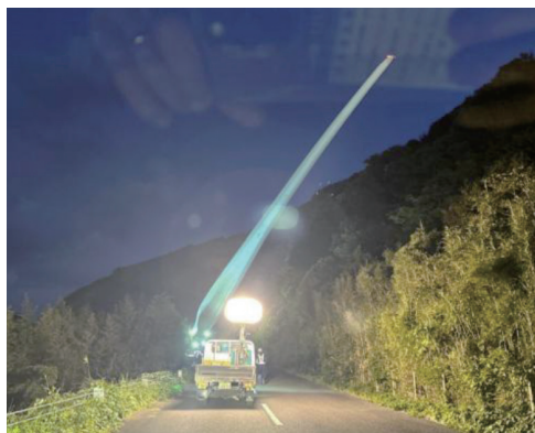
写真-9 ブレード運搬状況（約45°で上方へ持上げ中）
