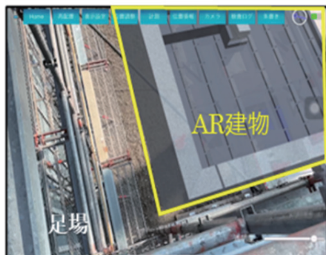
図-9 AR画像によるPCaとの緩衝確認
