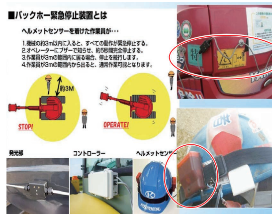
写真-5 スリーエスバックホー（緊急停止装置付バックホウ）
