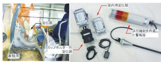
図-4 MPSと警報器と受信器によって構成する「土砂崩壊の簡易危険検出システム」
