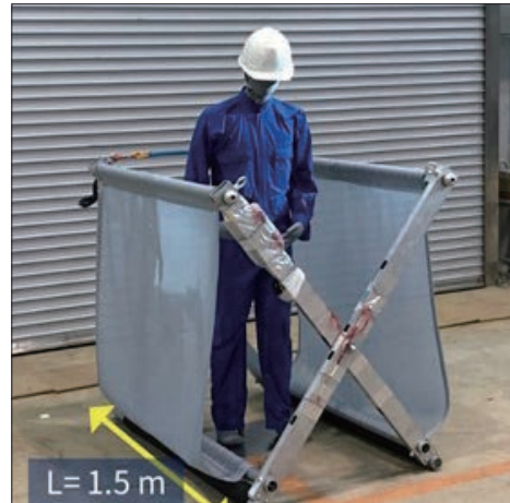
a) 実験用に試作した土砂ガード
