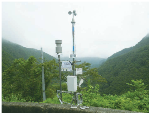
写真-3 気象観測装置（ハザード・アイ）
