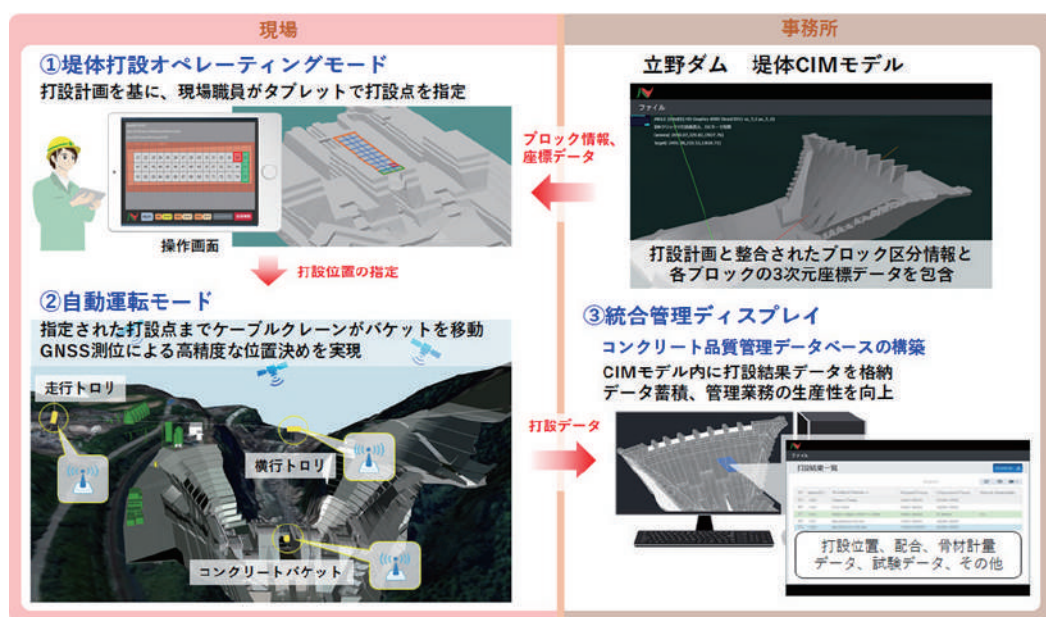
図-2 ケーブルクレーン自動運転システムの概要
