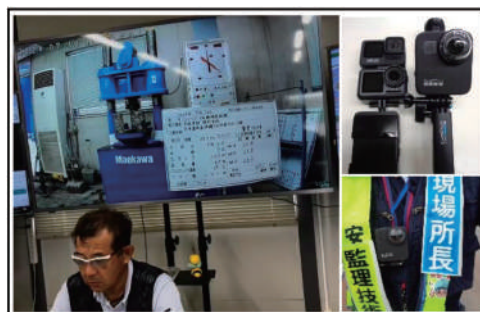
写真-4 ウェアラブルカメラによる立会状況とアクションカメラ
