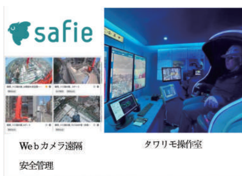
写真-10 Webカメラによる遠隔安全管理 タワリモ操作室
