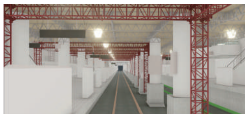
写真-5 BIMによる運転士目線の仮設図
