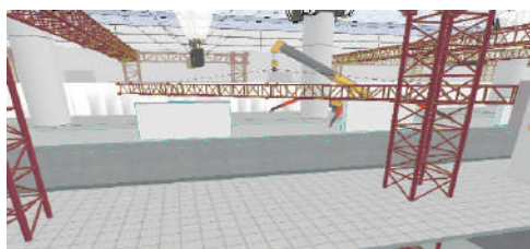
写真-6 BIMによる建て方計画
