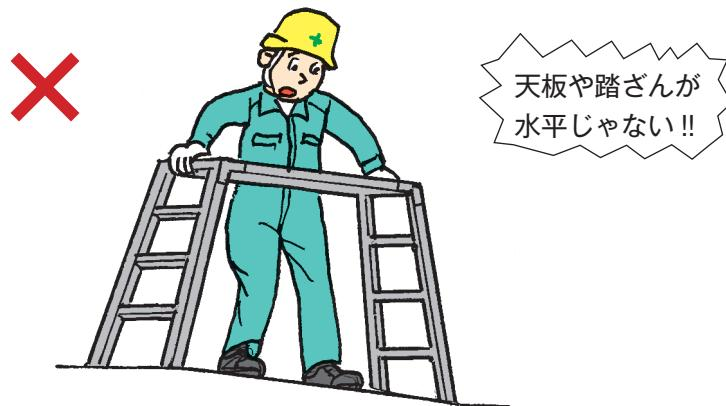
図3-32 軟弱地盤・傾斜地に設置しない
