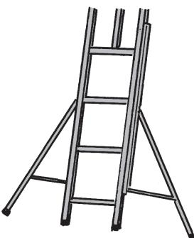
図3-7 安定性補助金具で安定させる一例
