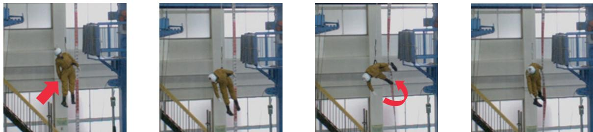
図4-12 脇ベルト型の人体ダミーの挙動
