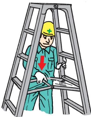
図3-19 開き止めのロックの例
