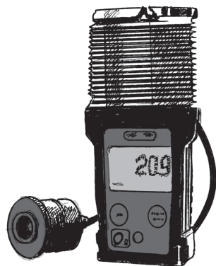
図3-2③ 携帯形ガス検知警報器 (拡散式) の例
