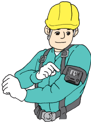
図 3-3 ① 装着形ガス検知警報器の装着使用例（腕に装着）
