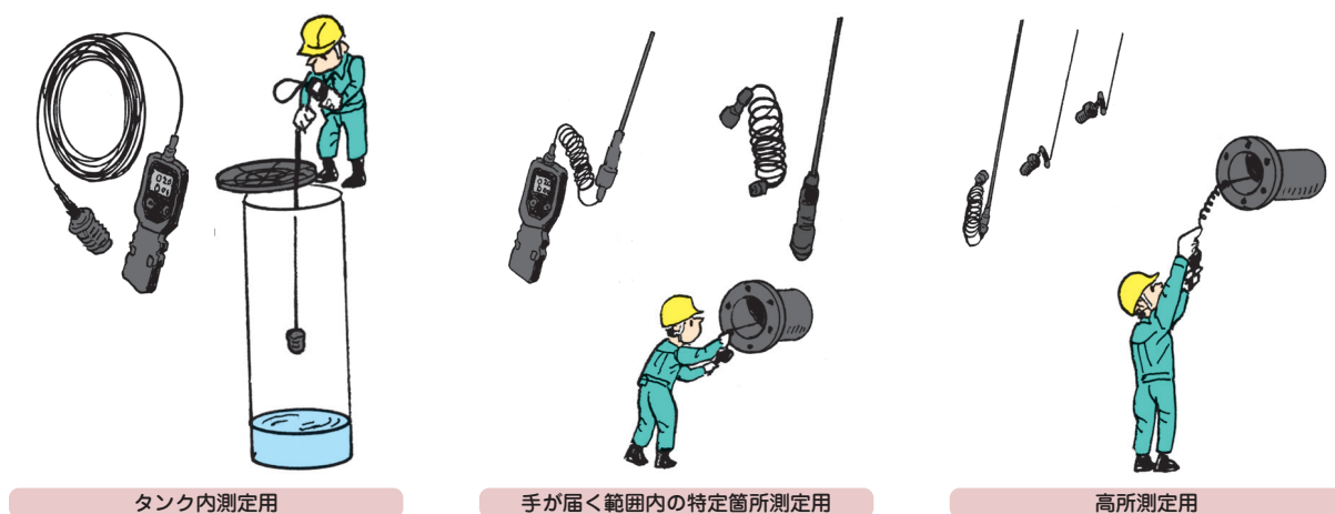
図３－２② 携帯形ガス検知警報器（吸引式）の使用例
