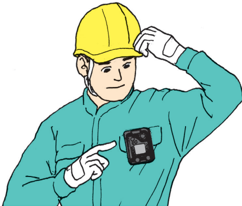
図 3-3 ② 装着形ガス検知警報器の装着使用例（胸ポケットに装着）
