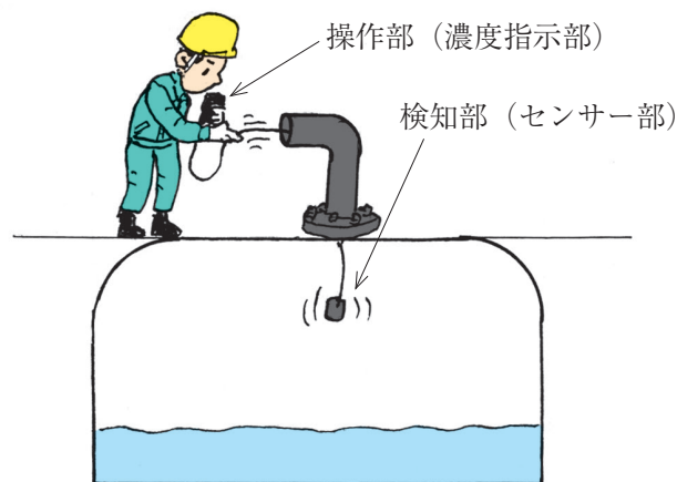
図3-2④ 携帯形ガス検知警報器 (拡散式) の使用例
