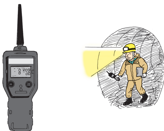
図３－２① 携帯形ガス検知警報器（吸引式）の例
