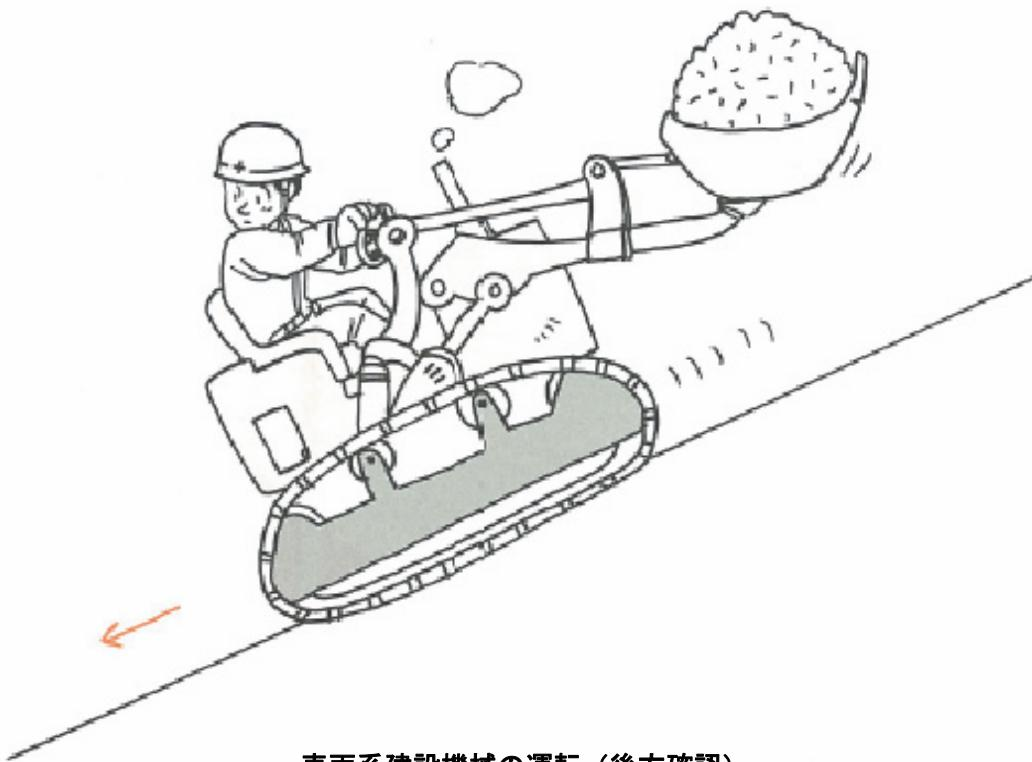
車両系建設機械の運転（後方確認）
