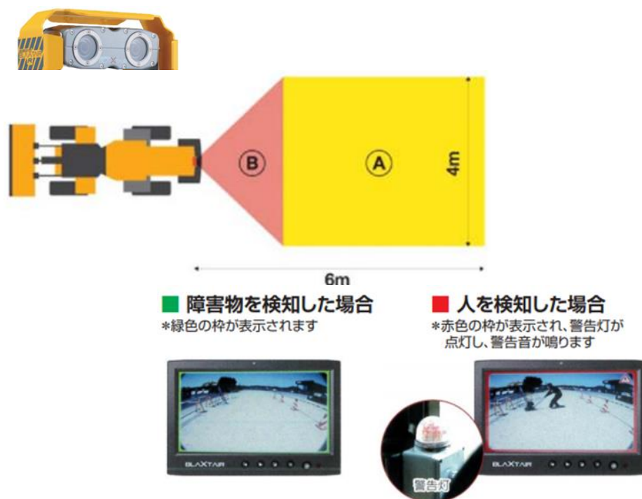
図 7 画像センサーによる人接近警報システム（資料提供：西尾レントオール（株））
