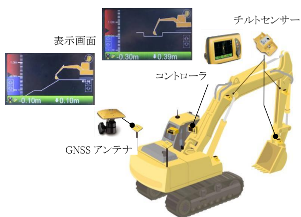
図5 油圧ショベルのMG機能事例 （資料提供：株式会社トプコン）
