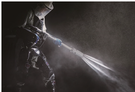
写真 6－5 高圧水取り扱い時の防護服及び作業
