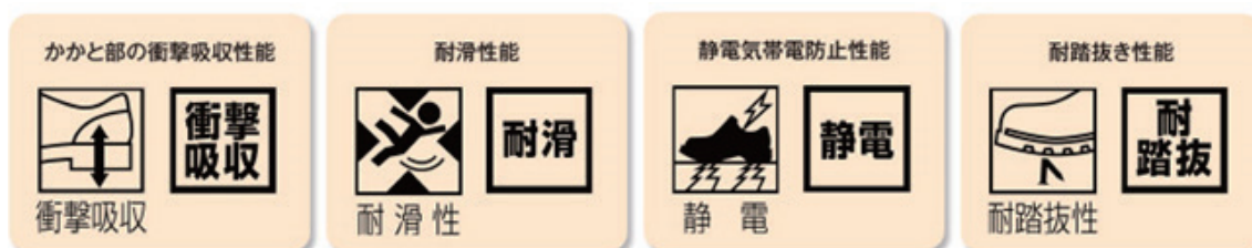
図 2-5 プロスニーカーの付加的性能を表すピクトグラム
