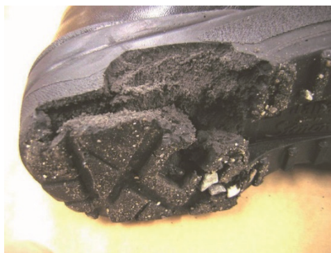
写真4－1 加水分解した靴底
