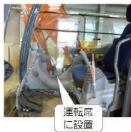
図3 左は受信器の表示部(最大5台の警報器から受信可能、ランプの色で監視中、注意、警報を示す)。右は重機運転席のカップホルダーに置いた受信器。
