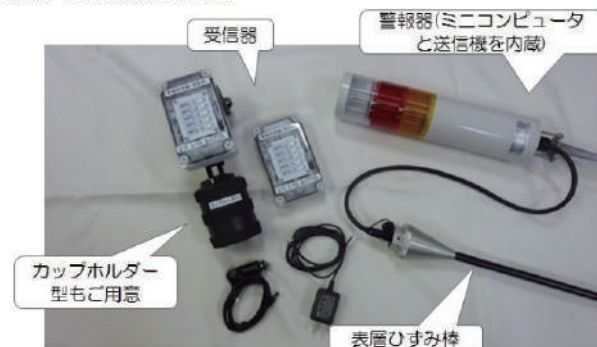
図2 右はMPSセンサーに接続した警報器(データ収録とその解析及びライトとブザーによる警報とそれを電波で送信する)。左と中央は受信器(電波を受信して警報を受取る。重機の運転席や事務所などに設置)
