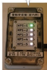
図3 左は受信器の表示部(最大5台の警報器から受信可能、ランプの色で監視中、注意、警報を示す)。右は重機運転席のカップホルダーに置いた受信器。
