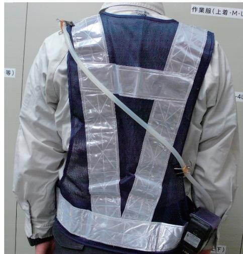
写真2 サンプラーセットを付けた図
