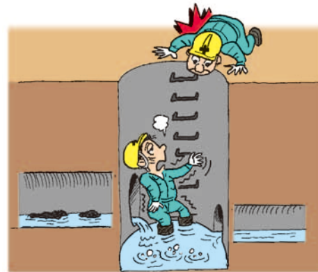
下水道工事での硫化水素中毒の例
