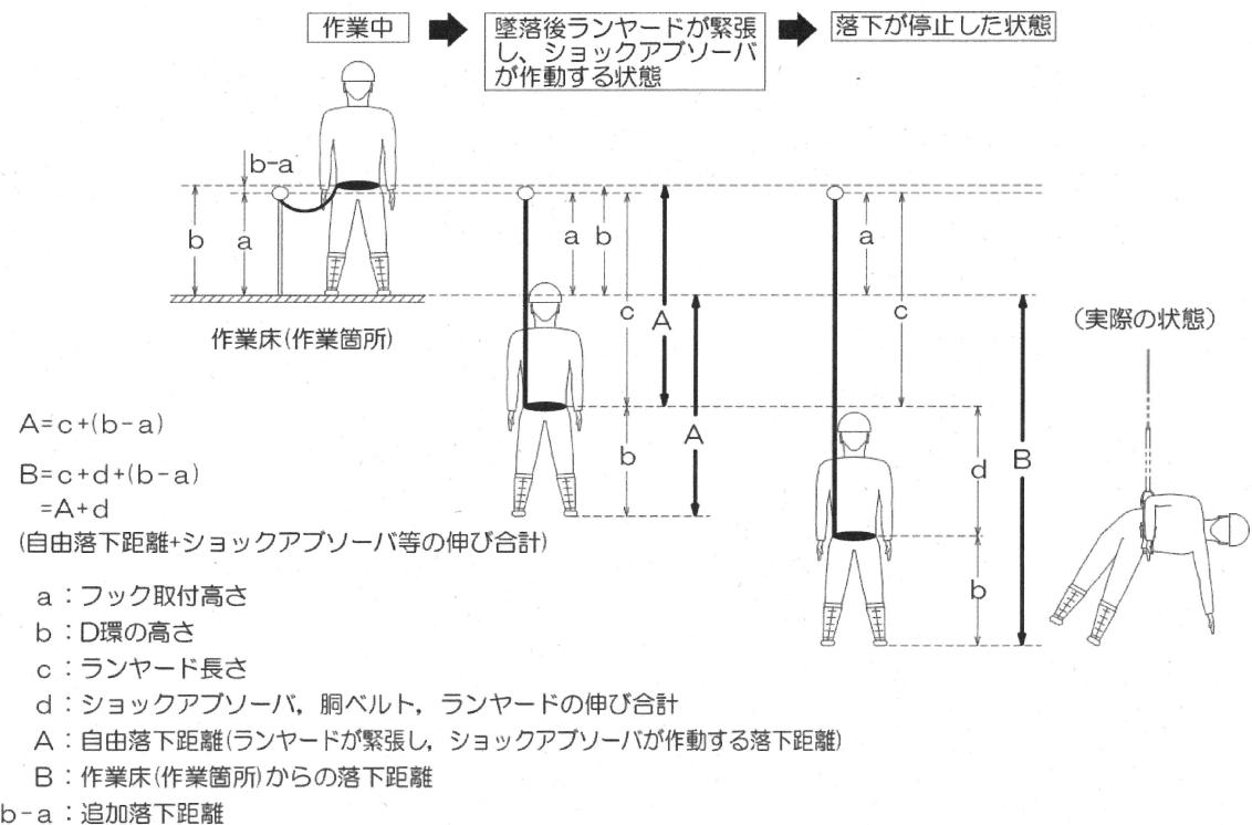
図2 脊ベルト型の落下距離等
