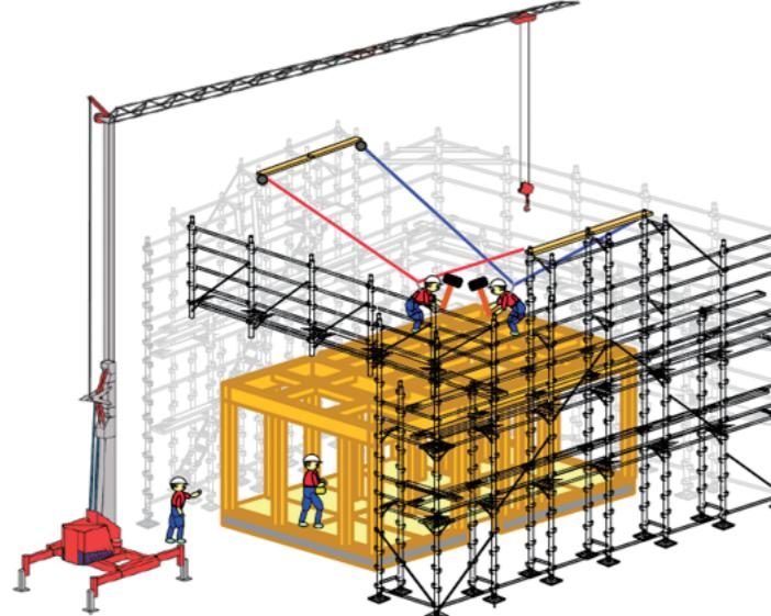
図2-33 スライドレール式安全ブロック工法を用いた作業方法の一例 (株)東京 BK 足場)
