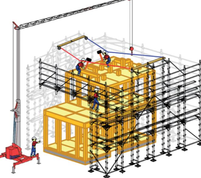
【建方作業】2階軸組・仮筋・小屋床施工・下屋・母屋組立
