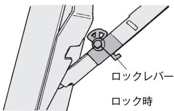
図3-35 開閉機構部のチェック
