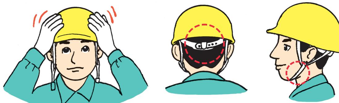
図4-21 保護帽の正しい着用方法の確認の仕方
