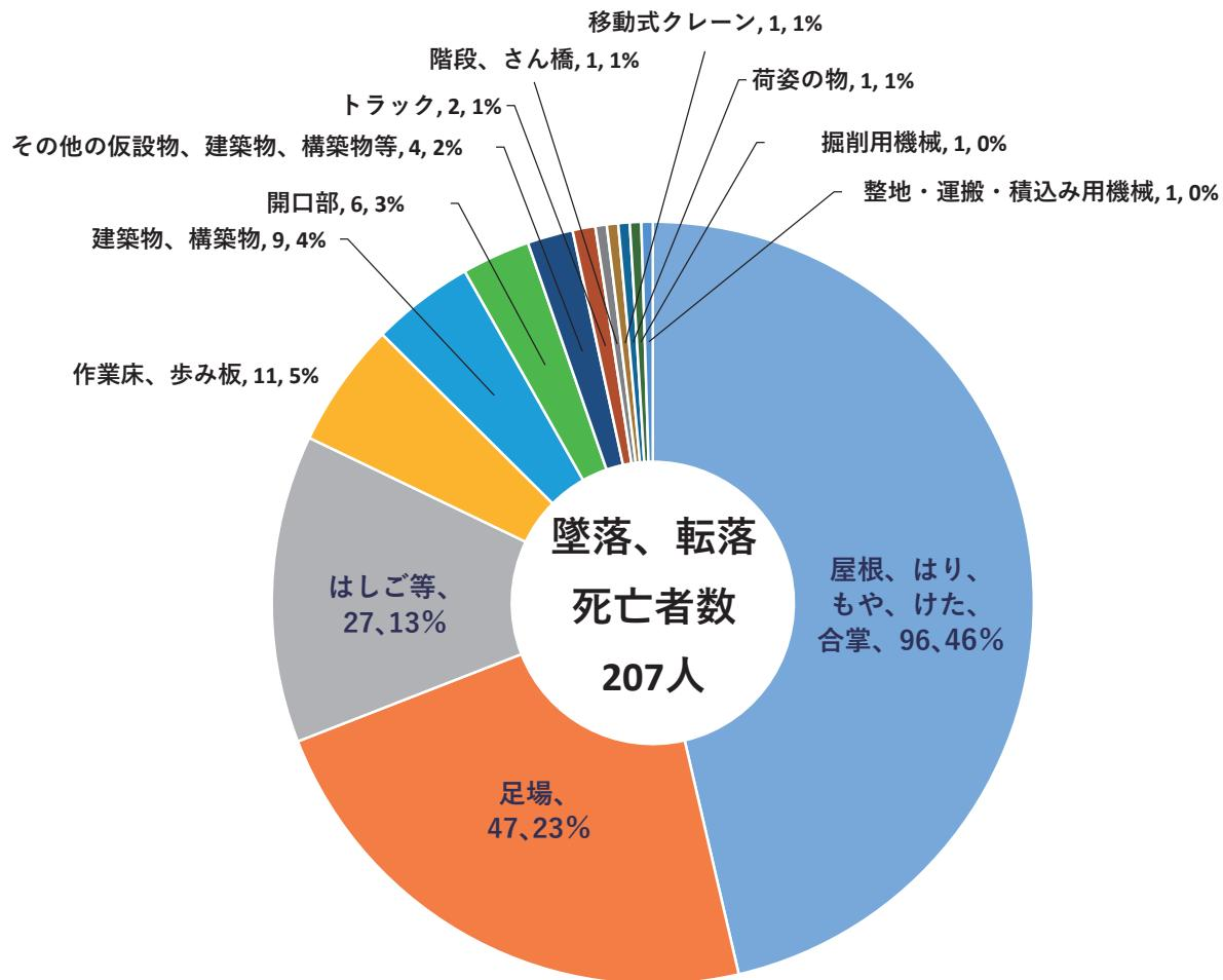
図1-3 木建工事における墜落・転落災害(死亡)の起因物(小分類)発生状況
