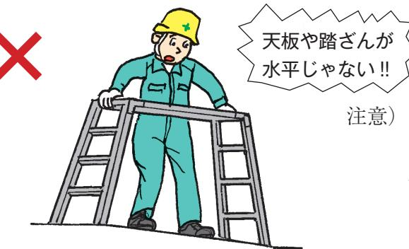
注意) アルミニウム合金製可搬式作業台は脚が伸縮するものが多く、同機能を利用して天板を水平にする。
