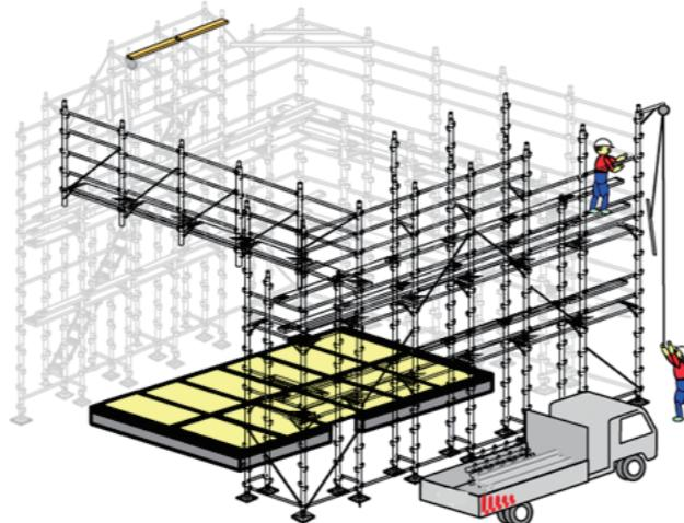
【先行足場組立】荷受架台組立・構造躯体搬入・安全ブロック設置
