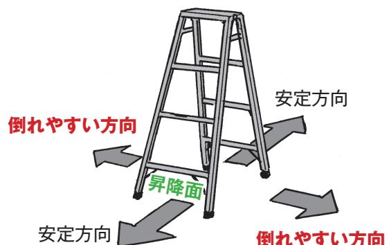
図3-26 脚立の安定方向と不安定方向
