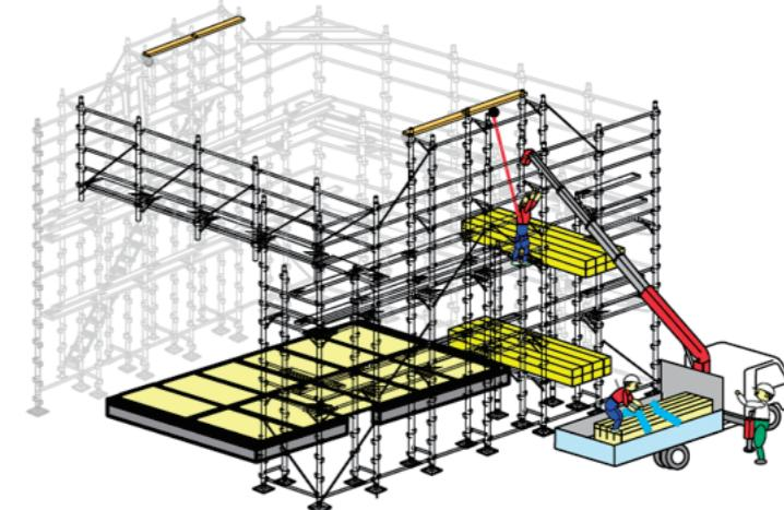
【建方作業】1階軸組み・仮筋・2階床施工
