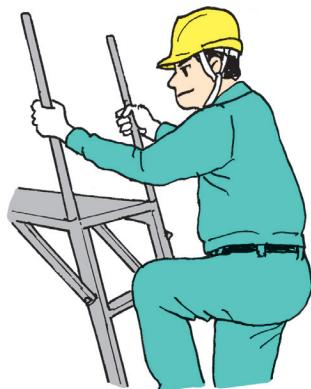
注意) (一社) 仮設工業会の認定では高さ1.5mを超えるアルミニウム合金製可搬式作業台に手がかり棒の設置を義務付けている。
