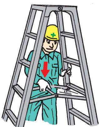
図3-19 開き止めのロックの例
