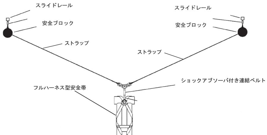
図2-32 安全ブロック工法の設置状況
