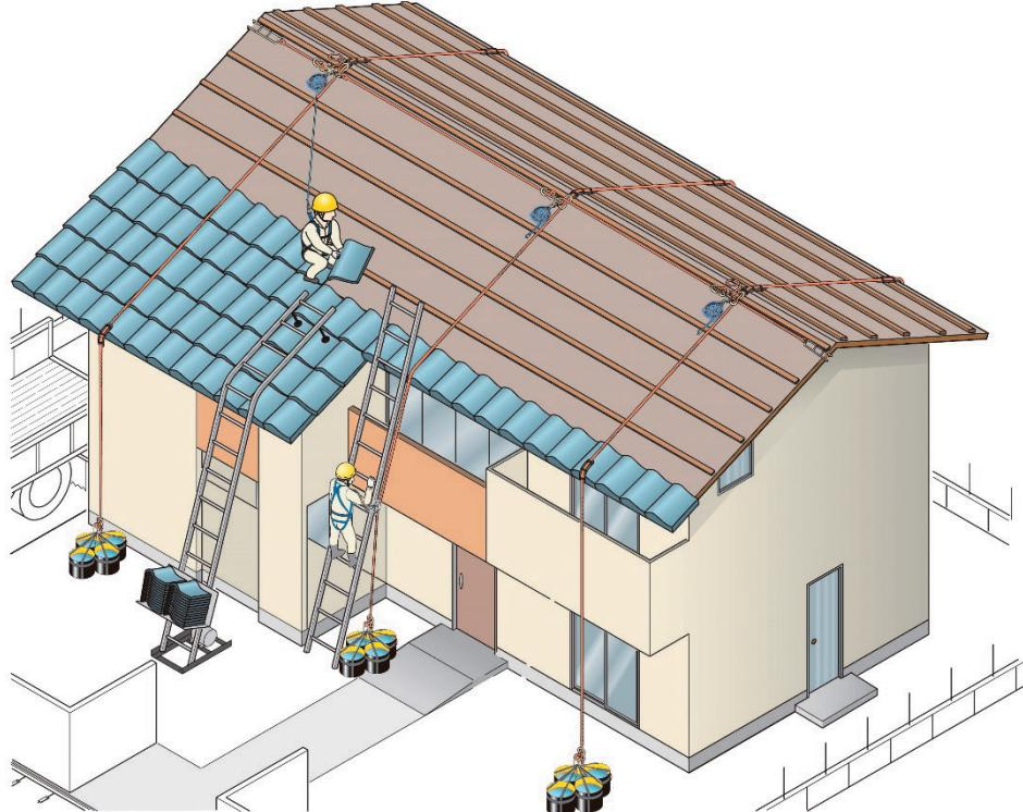
図2-39 屋根上の墜落・転落対策設置（例）
