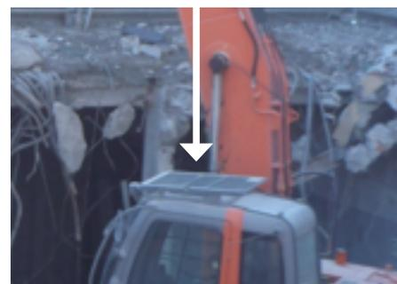
転倒時保護構造は、安衛則第157条の2において、「事業者は、路肩、傾斜地等であって、車両系建設機械の転倒又は転落により運転者に危険が生ずるおそれのある場所においては、転倒時保護構造を有し、かつ、シートベルトを備えたもの以外の車両系建設機械を使用しないように努めるとともに、運転者にシートベルトを使用させるように努めなければならない。」としている。よって、このような場所では、転倒時保護構造を有する車両系建設機械の使用と、この構造の車両系建設機械の運転にあたっては運転者はシートベルト（JISA8911の3.1）を着用することが必要である。また、運転室（キャビン）を有する車両系建設機械であっても、転倒時保護構造を有していないものも多数あるので、運転する車両系建設機械の運転室が転倒時保護構造を有しているかよく確認しておくことが必要である。転倒時保護構造（JISA8920の3.2）には、横転時保護構造（JISA8921の3.1）も含まれる。
