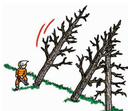
【かかり木に激突させるために かかり木以外の立木の伐倒】
