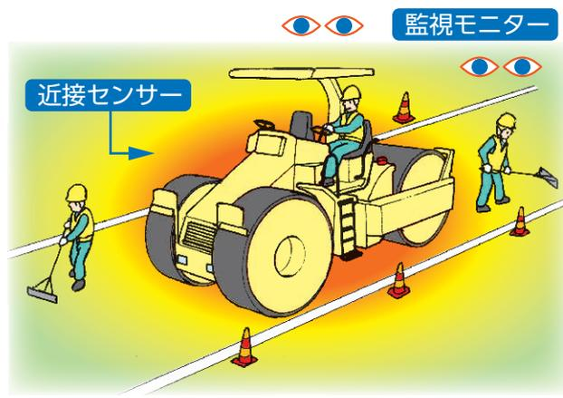
締固め用機械の安全装置の
